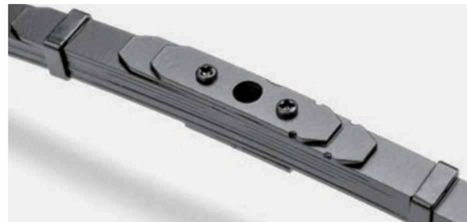
**Шаг 2.** Установите рессору на площадке левого кожуха полуоси заднего моста. В передней части рессоры должны располагаться два закругленных листа, а в задней один. Зафиксируйте рессору на кожухе моста винтом 2,0×6 (OM) сквозь накладку в средней части рессоры.
