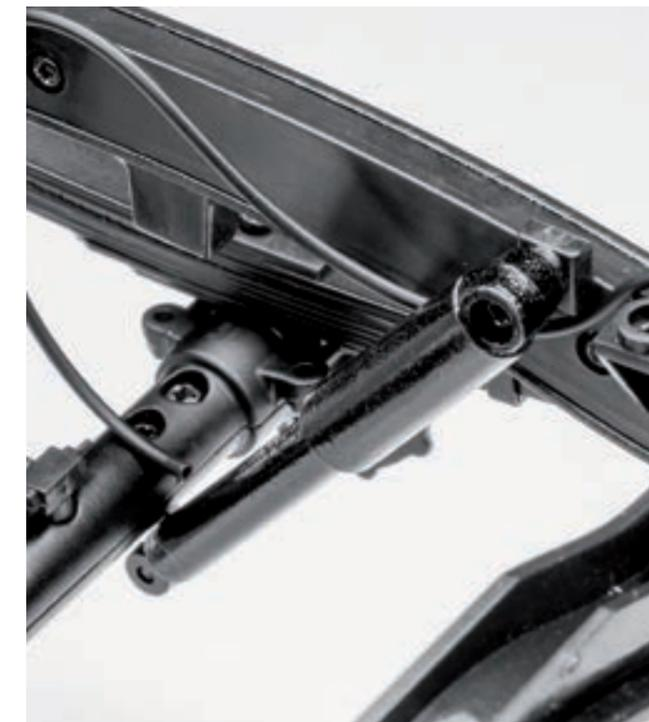
**Шаг 12.** Поверх пружины установите кожух амортизатора. При помощи винта 2,3×5 (LP) закрепите кожух амортизатора на кронштейне левого лонжерона рамы.
