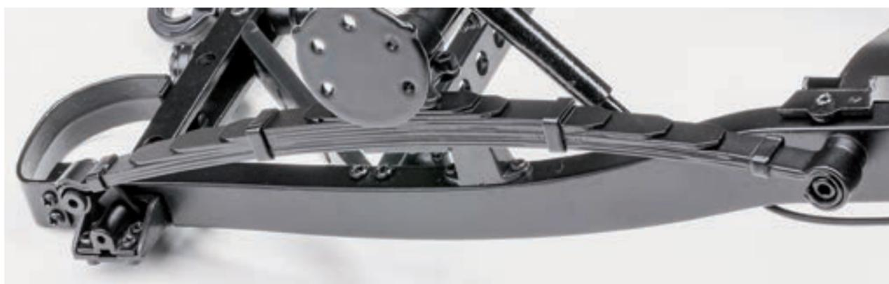
**Шаг 7.** Разместите собранный задний мост в задней части рамы модели. Установите передний конец левой задней рессоры на ось переднего кронштейна рессоры, расположенного на раме. Задний конец рессоры поместите на втулку серьги заднего кронштейна.
