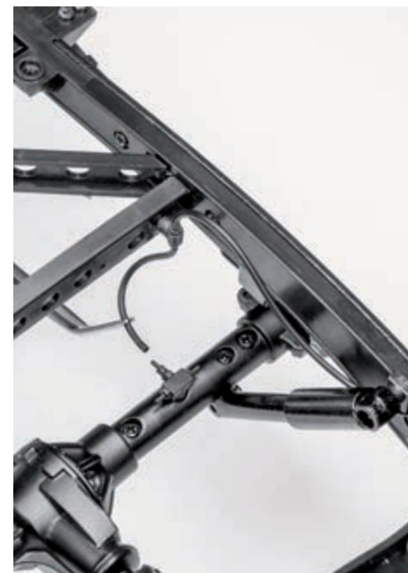
**Шаг 13.** Зафиксируйте свободный конец гибкого шланга задних тормозов на центральном выходе тройника заднего моста.
