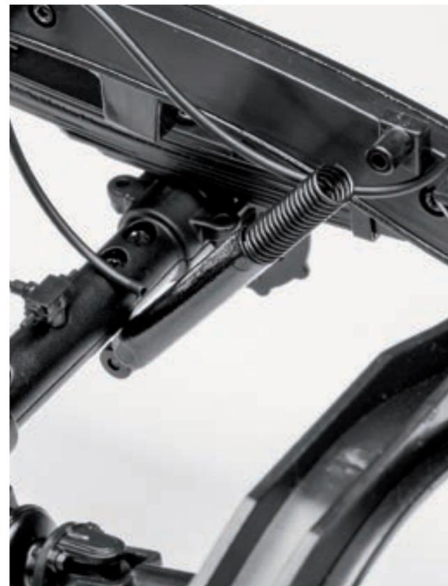
**Шаг 11.** Поместите пружину на шток левого амортизатора заднего моста.
