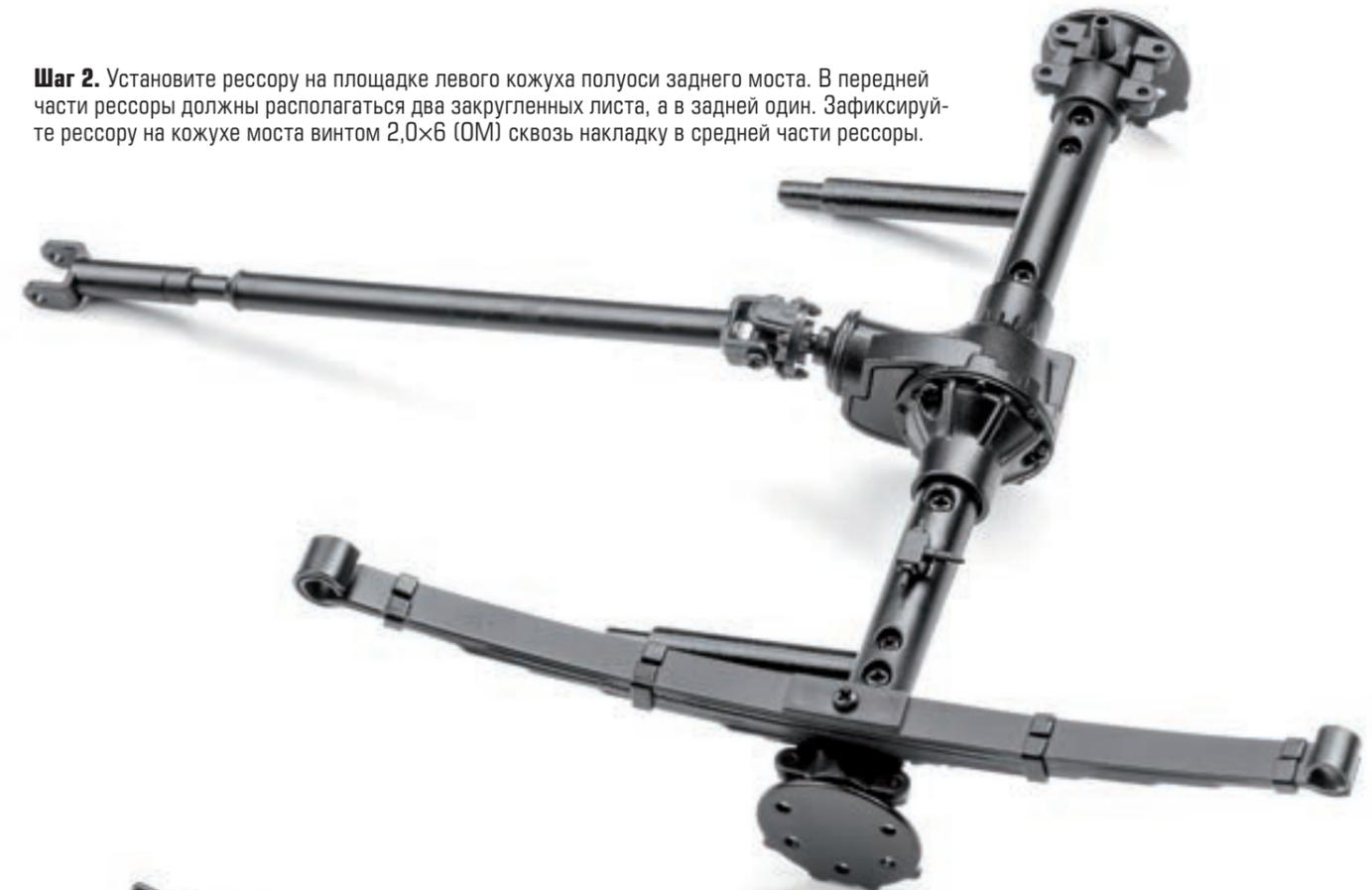
**Шаг 3.** Стремянки задней рессоры понадобятся при дальнейшей сборке модели. Если установить стремянки на данном этапе, они помешают креплению корпусов бортовых редукторов заднего моста.
