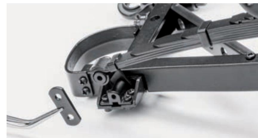
**Шаг 9.** Поверх кронштейна и рессоры установите вторую щеку серьги рессоры. Закрепите щеку на кронштейне винтом 2,0×4 (GM). Аналогичным образом при помощи винта 2,0×5 (IP) закрепите щеку серьги рессоры на втулке.
