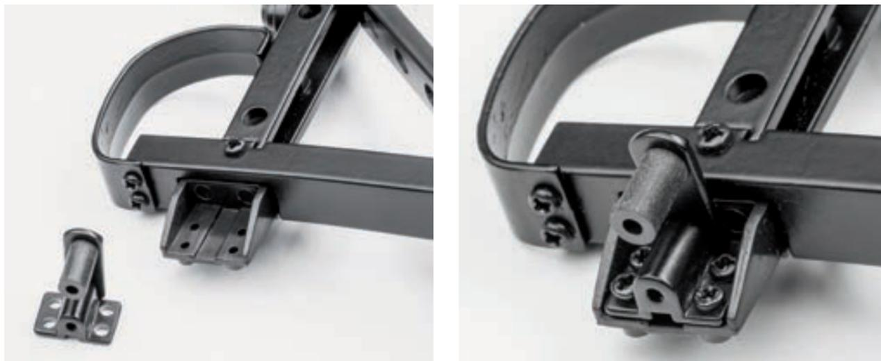
**Шаг 6.** Установите кронштейн внутрь задней левой опоры кронштейна серьги рессоры. При этом установленная ранее щека должна находиться внутри опоры. Закрепите кронштейн при помощи четырех винтов 2,0×4 (EP).
