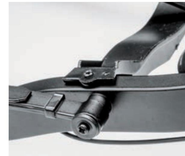
**Шаг 8.** При помощи винта 2,3×4 (PM) и специальной шайбы закрепите передний конец задней рессоры на раме.
